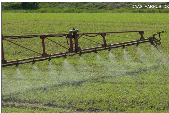
Rys. 18 Zastosowanie rozpylaczy płaskostrumieniowych 110° -120° i prowadzenie belki polowej na wysokości 35-50 cm pozwala na uzyskanie równomiernego rozkładu cieczy na opryskiwanej powierzchni
