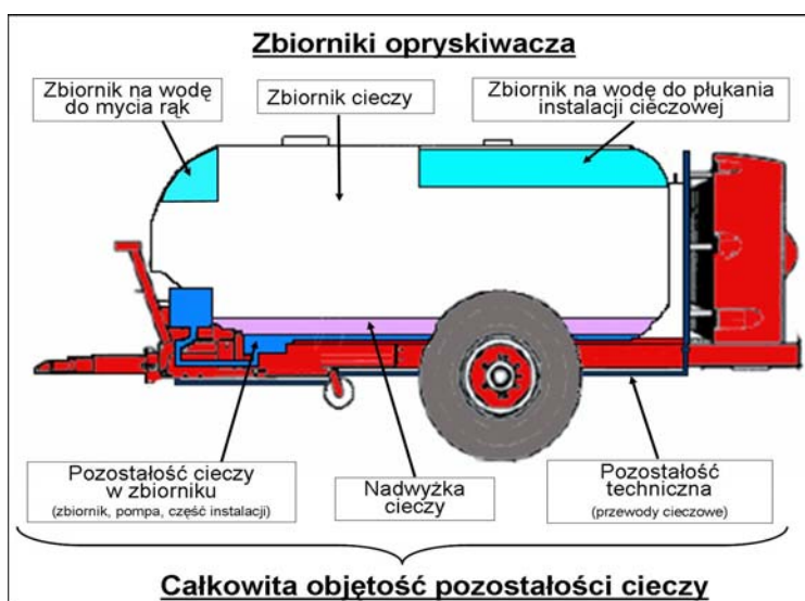
Rys. 42 Zbiorniki opryskiwacza i pozostałości cieczy
