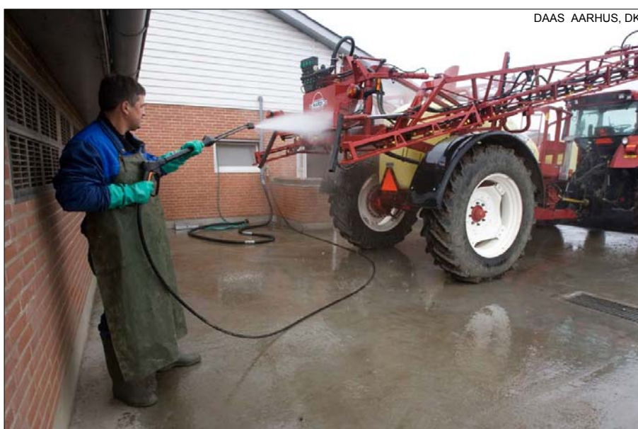
Rys. 31 Ciśnieniowe mycie zewnętrzne opryskiwacza na nieprzepuszczalnym podłożu
