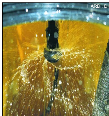
Rys. 30 Zraszacz do ciśnieniowego płukania zbiornika
