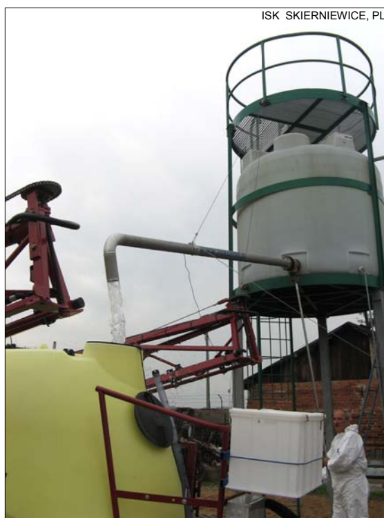
Rys. 17 Najlepszym rozwiązaniem jest napełnianie opryskiwacza ze zbiornika pośredniego
