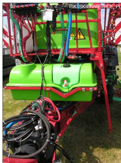
Rys. 28 Opryskiwacz z dodatkowym zbiornikiem na wodę do mycia instalacji cieczowej
