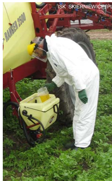
Rys. 12 Sporządzanie cieczy użytkowej na polu przy użyciu rozwadniacza
