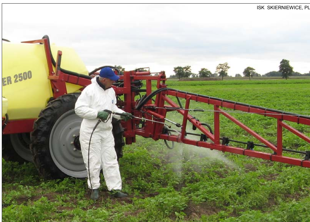
Rys. 29 Zewnętrzne mycie opryskiwacza na polu przy użyciu lancy ciśnieniowej
