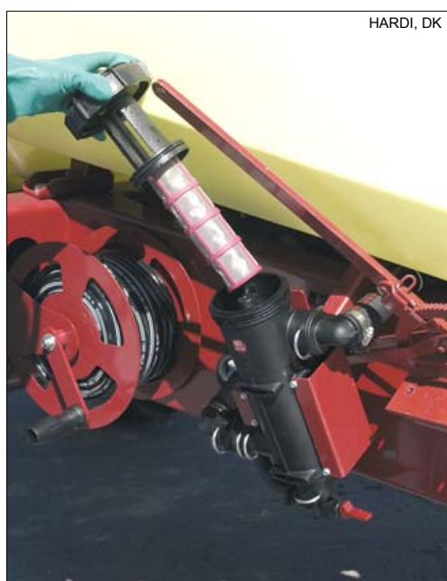
Rys. 33 Oczyszczanie filtrów nie powinno stwarzać ryzyka wycieku cieczy użytkowej
