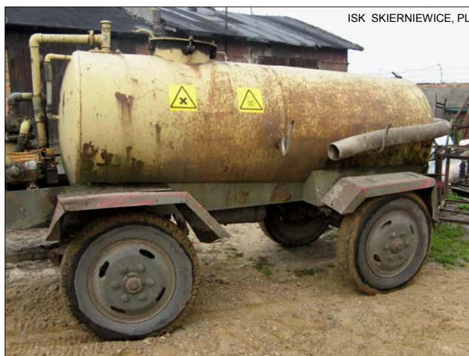
Rys. 39 Zbiornik do przechowywania płynnych pozostałości do czasu ich wykorzystania lub bezpiecznej utylizacji musi być wyraźnie oznaczony
