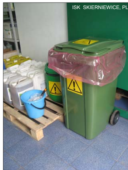
Rys. 6 Magazyn powinien być wyposażony w sztuczne oświetlenie, wentylację i półki z materiału nienasiąkliwego, Posadzka powinna być nienasiąkliwa i łatwo zmywalna. W wydzielonym miejscu powinny znajdować się pojemniki na skażone odpady oraz na puste opakowania po środkach ochrony roślin
